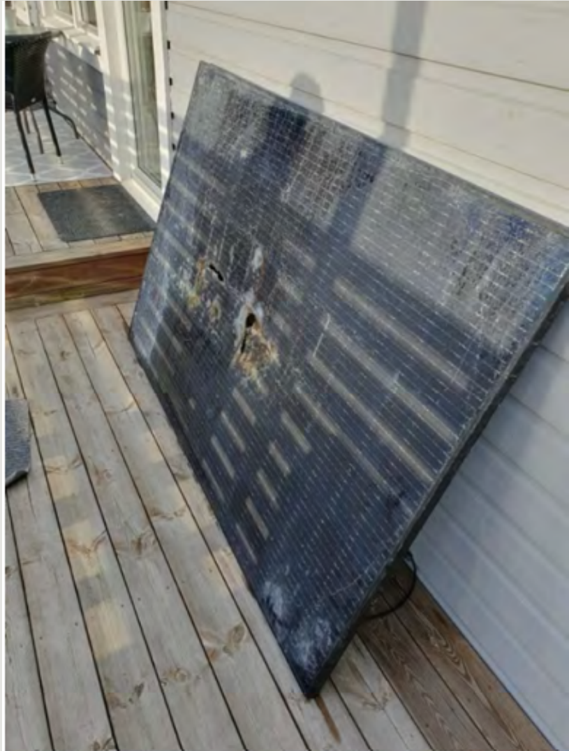
Figur 5. Framsidan av solpanel som branden inträffade i.
